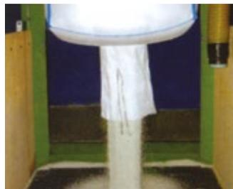
Bocca inferiore con valvola di scarico
